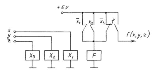
Это релейно-контактная схема реализации переключательной функции  $f(x,y,z) = \overline{x} \lor y \lor \overline{z} \ \text{с реле-повторителями сигналов датчиков.}$
